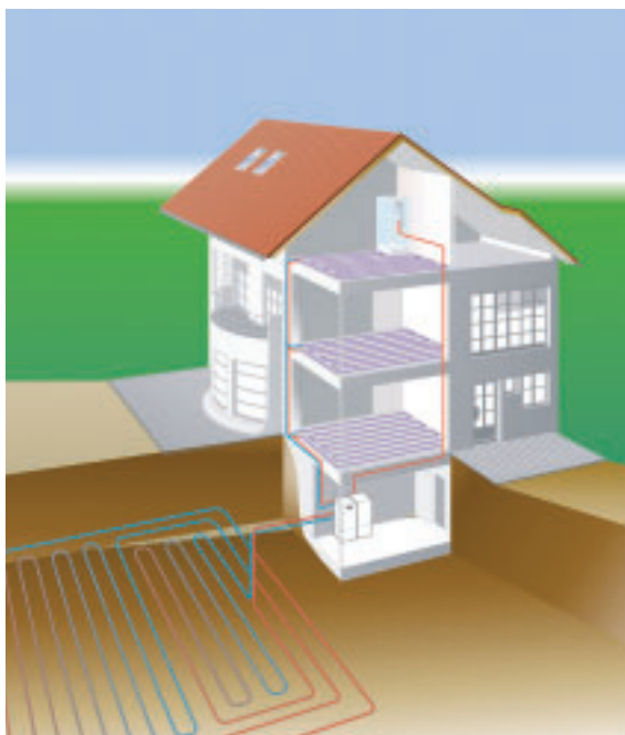
Schema einer Wärmepumpe mit Erdsonden (links) und mit Erdkollektor (rechts). Beide Wärmepumpen nutzen Erdwärme. Quelle: Max Weishaupt GmbH
